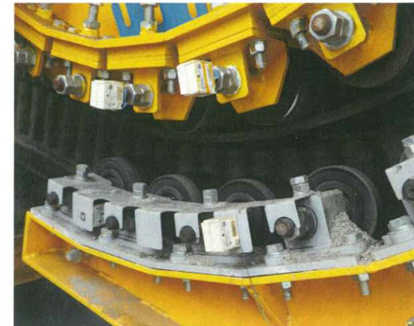
デモ機に設置された磁石式の振動熱センサー
