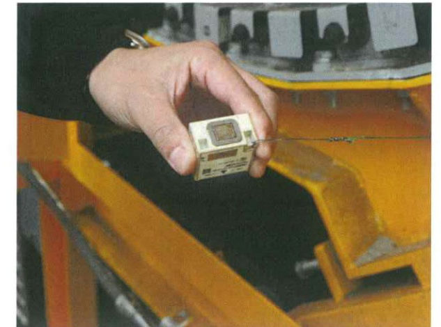
デモ機に設置された磁石式の振動熱センサー
