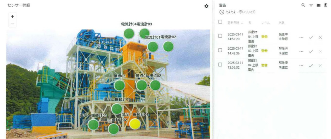
クラウドサーバーのセンサー警告画面。異常を検知した箇所は色が変わる仕様に
