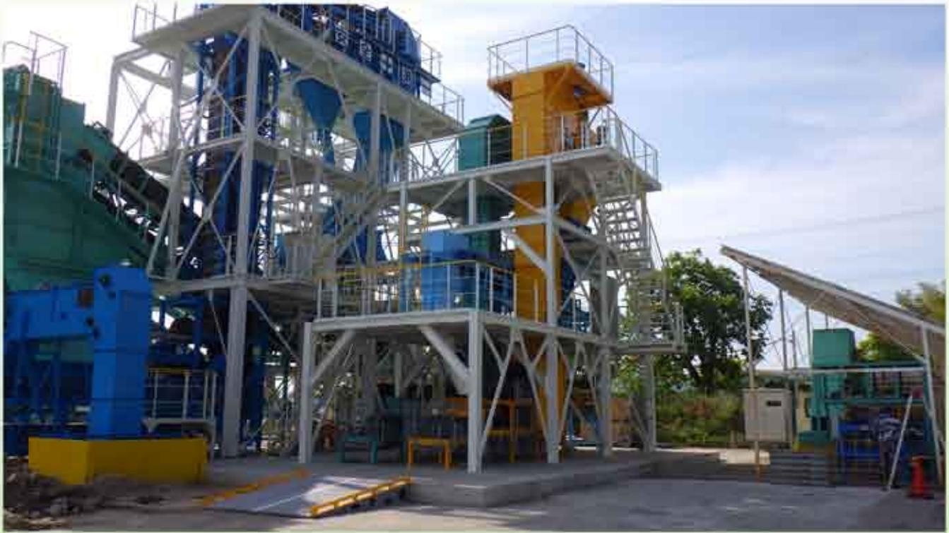
従来の急傾斜ベルト（垂直Sコンベヤ）と垂直二枚目君を並列に配置、
